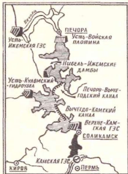
Схема гидросооружений в верховьях рек Печоры, Вычегды и Камы.
